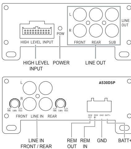
1\* In seltenen Fällen wird die Auto-Turn-On Funktion mit älteren Autoradios nicht arbeiten. Falls Sie auf dieses Problem treffen, stecken Sie bitte das mitgelieferte „ACC-IN“ Kabel in den Anschlussstecker und verbinden es mit dem ACC/Amp Remote Anschluss des Radios oder einem anderen Kabel, welches +12 V liefert, sobald das Radio eingeschaltet ist.
