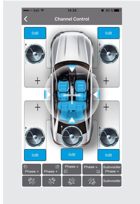
Sur le bas de l'écran de ce menu, la ligne haute contient les icônes pour régler la phase. De la gauche vers la droite : avant gauche, avant droite, arrière gauche, arrière droite, subwoofer.
