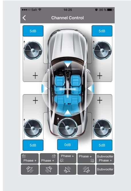
Im unteren Bereich des Menüs befinden sich in der oberen Zeile die Icons zum Einstellen der Phase. Von links nach rechts: Front links, Front rechts, Hinten links, Hinten rechts, Subwoofer.
