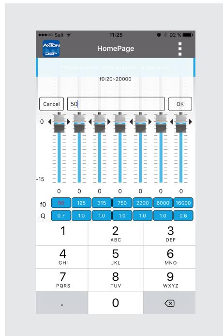
Sie können bei Bedarf für die Front und Rückkanäle unabhängige Equalizer Einstellungen wählen. Drücken dafür einfach auf Front P.EQ bzw. Rear P.EQ.
